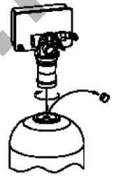
Удалить заглушку, закрепить вентиль
